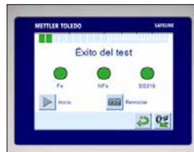
Un mensaje en la pantalla confirma el estado de la comprobación con cada tipo de metal. La luz verde indica un aprobado.
